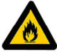
Εύφλεκτες ύλες ή/ και υψηλή θερμοκρασία
