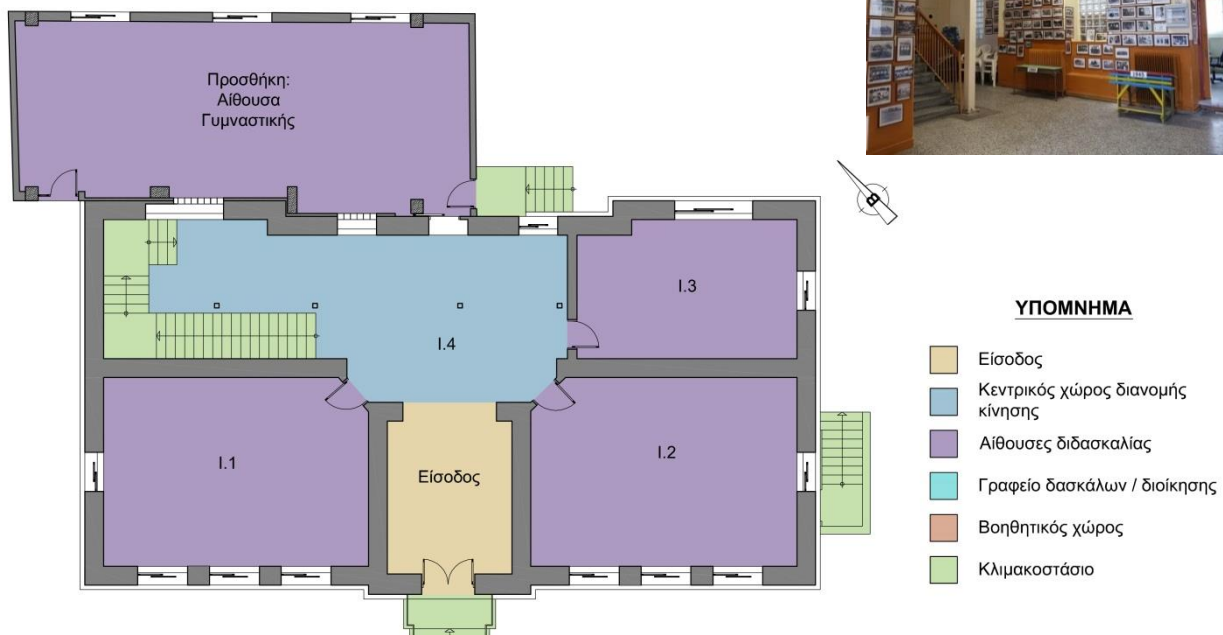
Εικόνα 31. Κάτοψη ισογείου: τυπολογική διάρθρωση
